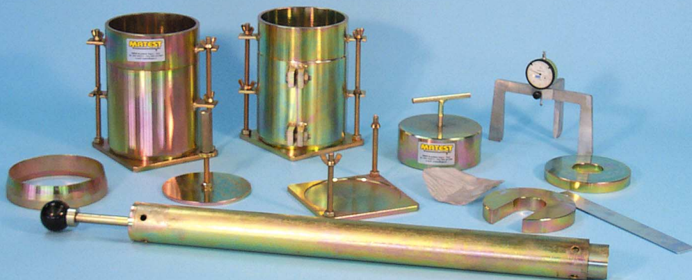
S200-01... CBR SET TO ASTM, AASHTO, CNR/UNI, UNE STANDARDS
